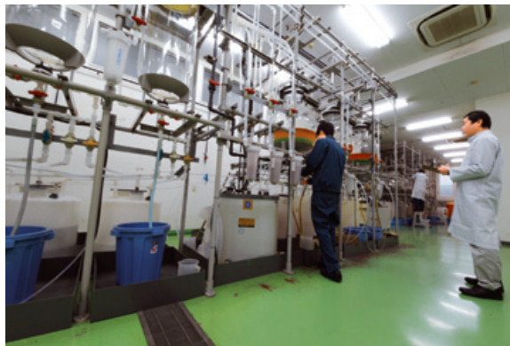
東京工場溶媒抽出設備
