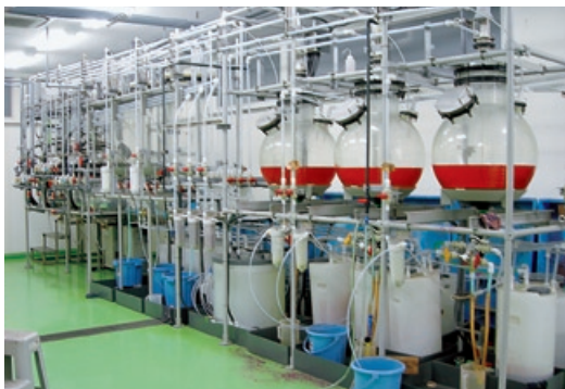
東京工場溶媒抽出設備
